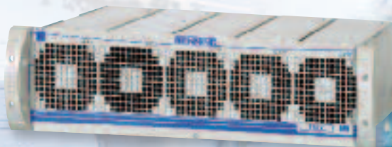
Рис. 3: 19-ти дюймовая несущая корзина с 5 выпрямительными модулями ТЕВЕСНОР 3000 I Выходное напряжение постоянного тока 110 В, суммарный выходной ток 100 А
