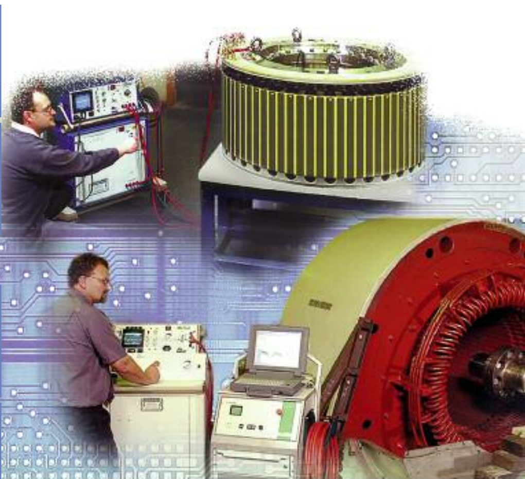
Mesures électriques selon VDE, par exemple le contrôle de haute tension, tension de choc et mesures des décharges partielles
