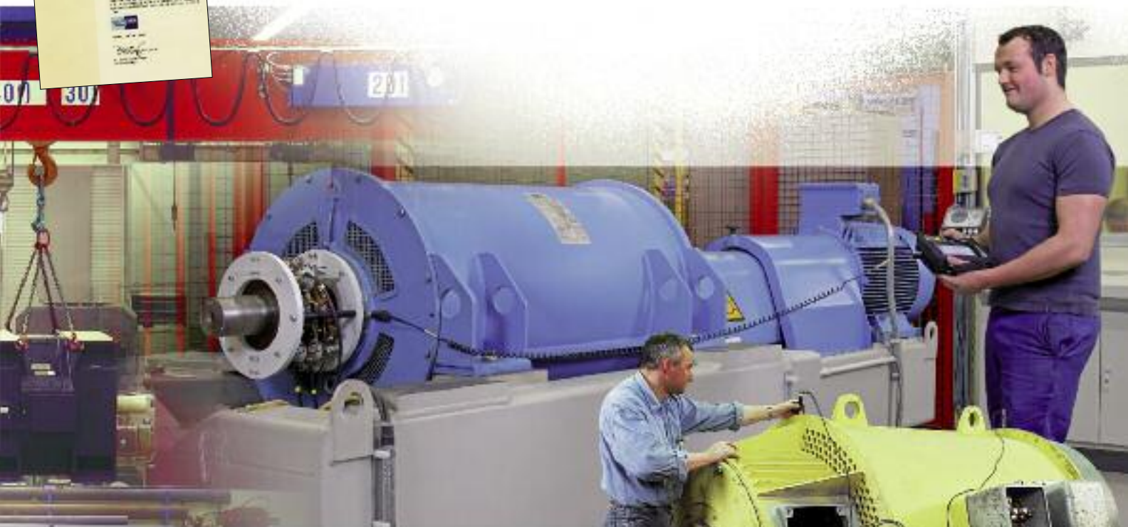
Contrôle final d'un accouplement magnétique sur la plate-forme d'essais BENNING
