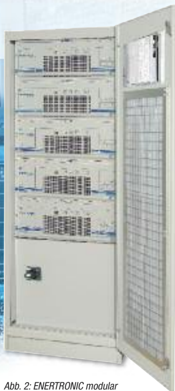
Abb. 2: ENERTRONIC modular mit 20 kVA Leistungsmodulen, Ausgangsleistung 80 kVA (n+1)
