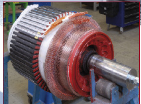
► Ein Gleichstromläufer wird neu bewickelt
