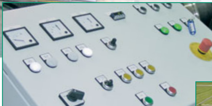
► Das Bedienfeld des mobilen Prüfstandes
