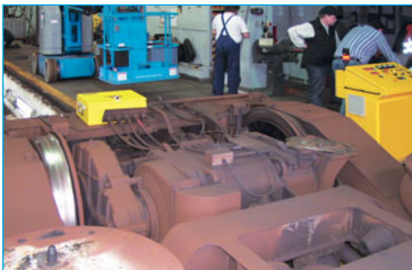
▶ Mobiler Prüfstand DC im Einsatz am Drehgestell
